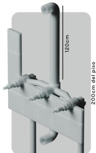
**Nota:** La instalación de un "dos llaves lluvia" deberá ser realizada de igual manera, excluyendo la instalación de la bajada y pico de bañera.
