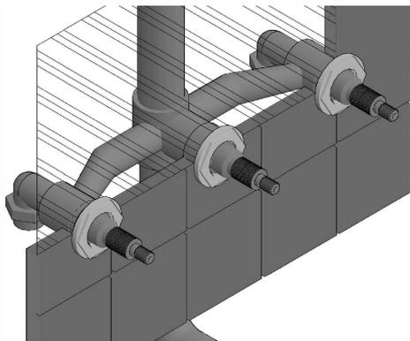
6. UNA VEZ RETIRADO LOS TUBOS Y DE TERMINAR DE REVESTIR LA PARED COLOQUE LAS TUERCAS DE SUJECIÓN ROSCANDOLAS EN LOS CABEZALES.
