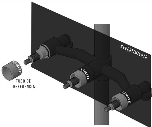
LA ETIQUETA DE LÍMITE DEBERÁ ESTAR CUBIERTA POR EL REVESTIMIENTO. SI EL REVESTIMIENTO QUEDARA POR DELANTE DE LA LÍNEA DE REFERENCIA DE LOS TUBOS O MUY POR DETRÁS DE ESA LÍNEA ES POSIBLE QUE EL ARMADO DE LA GRIFERÍA NO LLEGUE A SER CORRECTAMENTE REALIZADO.
